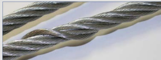
Lockerung der Außenlage
