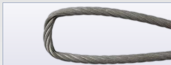
Quetschungen im Auflagebereich
