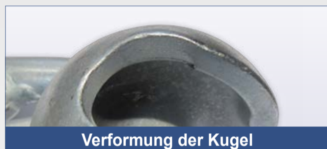
Druckstellen durch Anschlagmittel
