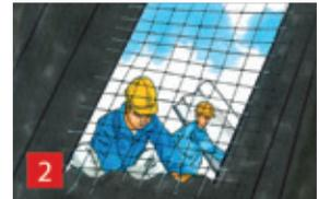
Fanggerüste bzw. Fangnetze dürfen als Auffangeinrichtung nur verwendet werden, wenn sich ein Seitenschutz aus arbeitstechnischen Gründen nicht einsetzen lässt.
