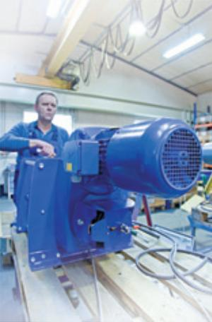
Elektroseilwinde bei der Montage
