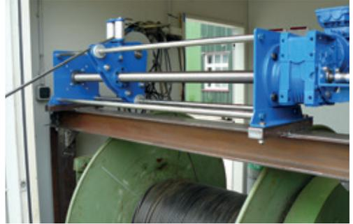
Spulvorrichtung für Elektroseilwinde
