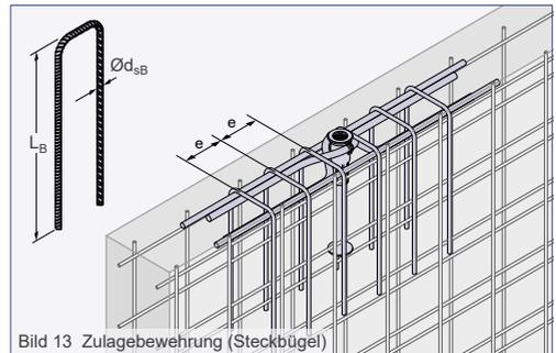
Bild 13 Zulagebewehrung (Steckbügel)
