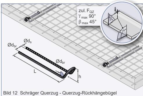
Bild 12 Schräger Querzug - Querzug-Rückhängebügel
