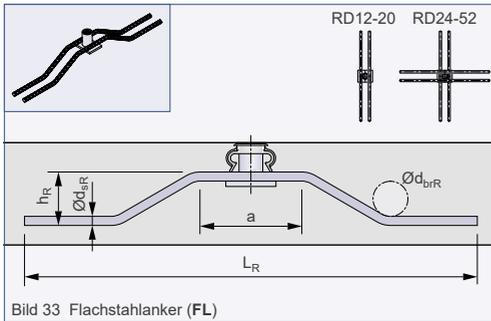
Bild 33 Flachstahlanker (FL)
