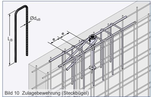
Bild 10 Zulagebewehrung (Steckbügel)
