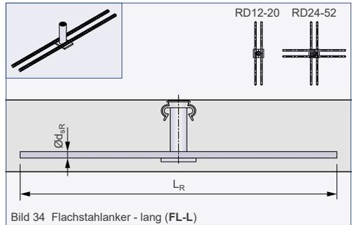
Bild 34 Flachstahlanker - lang (FL-L)
